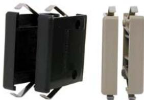
Einbaufertige Blöcke werden aus Anzeigemodulen und den linken und rechten Abschlusswinkeln gebildet. Mit zwei Gewindestangen und Schlitzmuttern werden sie zu einem Block verschraubt. Schnappfedern sorgen für sicheren Halt in der Frontplatte.
