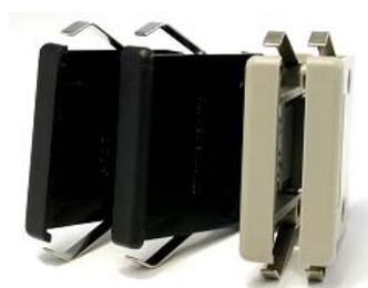
Einbaufertige Blöcke werden aus Anzeigemodulen und den linken und rechten Abschlusswinkeln gebildet. Mit zwei Gewindestangen und Schlitzmuttern werden sie zu einem Block verschraubt. Schnappfedern sorgen für sicheren Halt in der Frontplatte.
